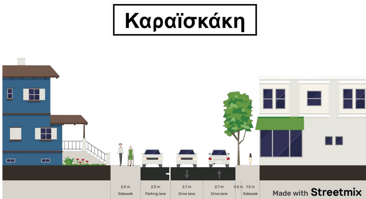
Εικόνα 4: Διατομή προτεινόμενης προσβάσιμης Διαδρομής 2 επί της οδού Καραϊσκάκη (Πηγή: Streetmix, ιδία επεξεργασία)
