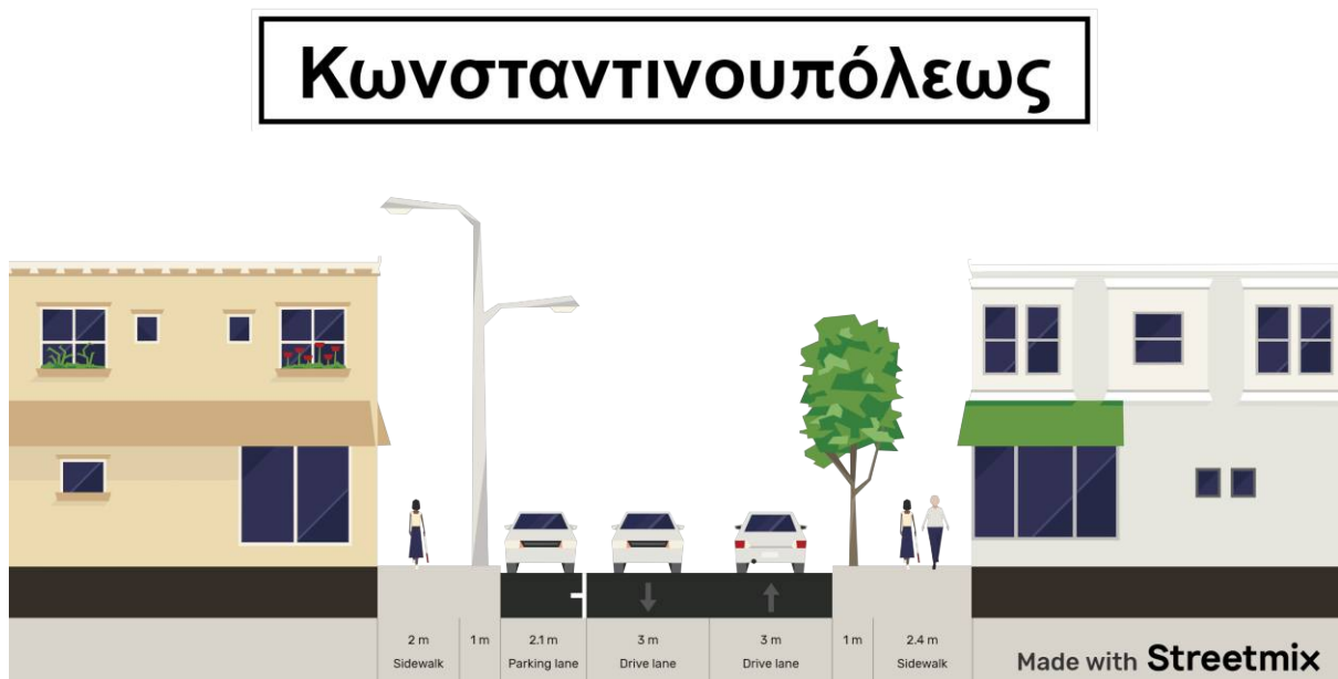
Εικόνα 12: Διατομή προτεινόμενης προσβάσιμης Διαδρομής 6 επί της οδού Κωνσταντινουπόλεως (Πηγή: Streetmix, ίδια επεξεργασία)
